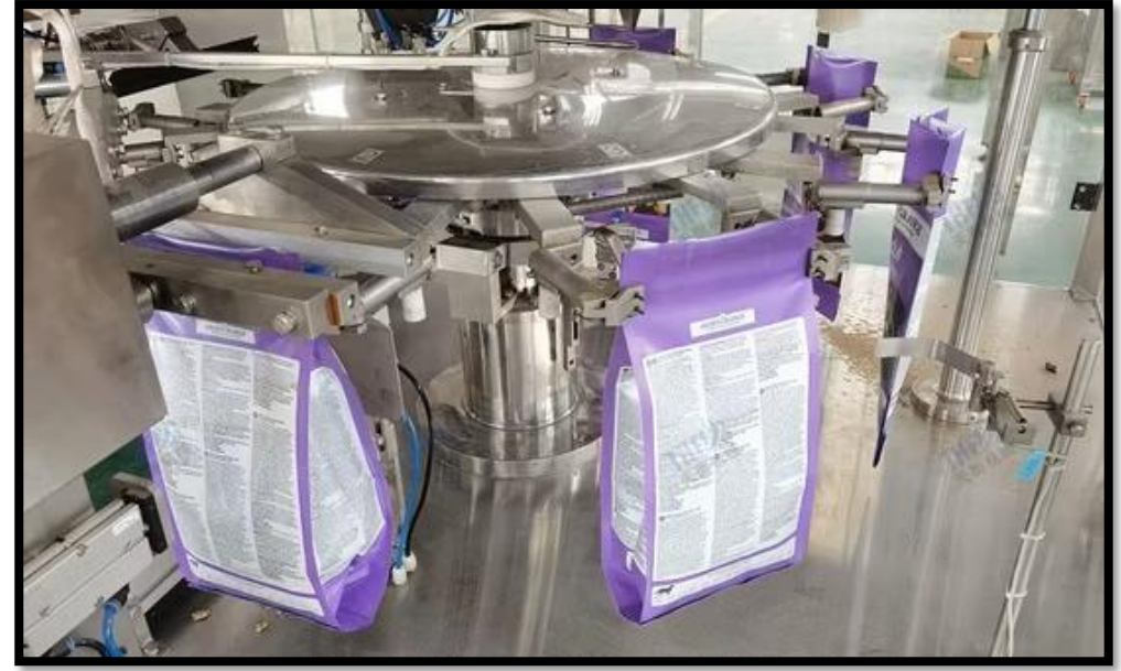
เครื่องซีลถุงสุญญากาศ (Vacuum Seal) ดูดอากาศออกและซีลถุงไว้ เพื่อรักษาคุณภาพและยืดอายุสินค้า
