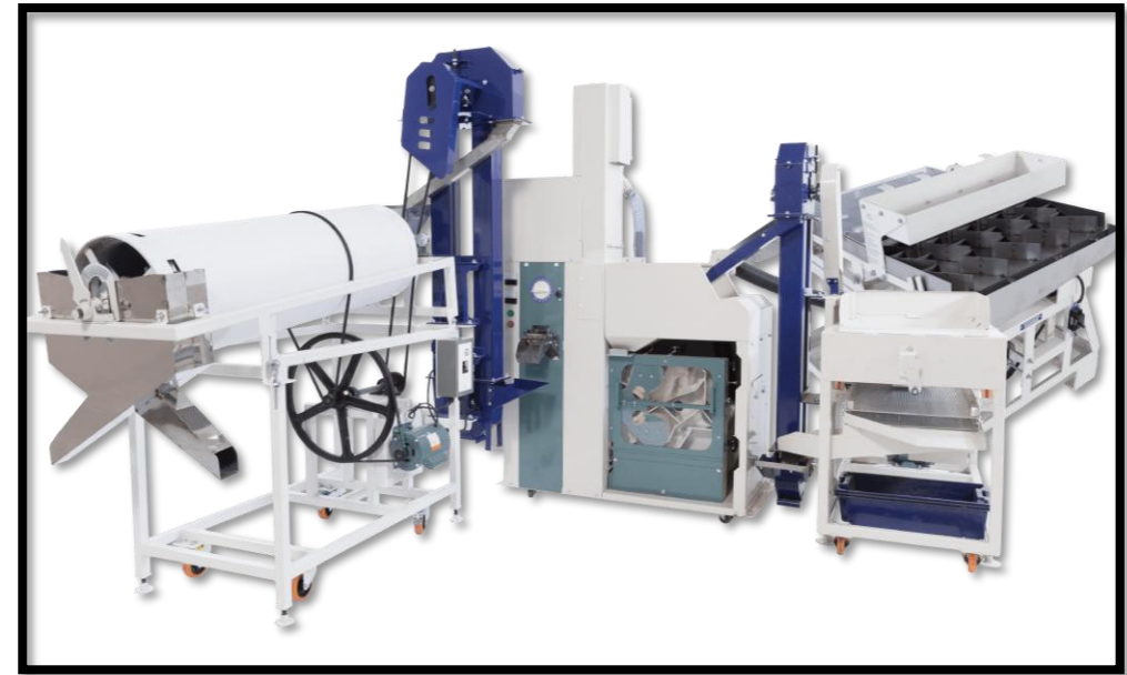
เครื่องสีข้าว (Miller) ขัดเอารำและจมูกข้าวออกจากข้าวกล้องให้กลายเป็นข้าวขาว
