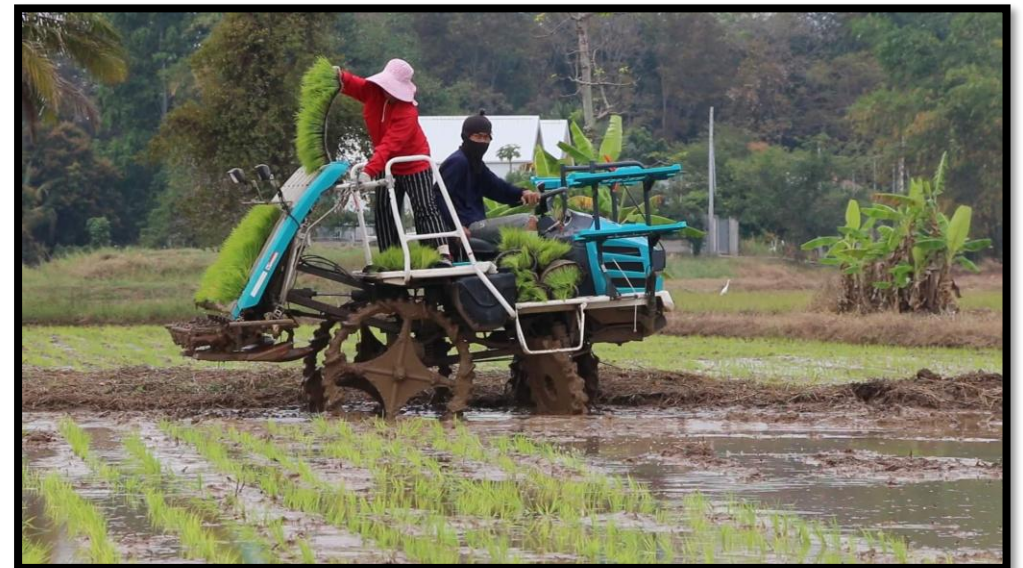
เครื่องดำนาข้าว ช่วยปลูกต้นกล้าเป็นระเบียบ ลดแรงงานและเพิ่มผลผลิต
